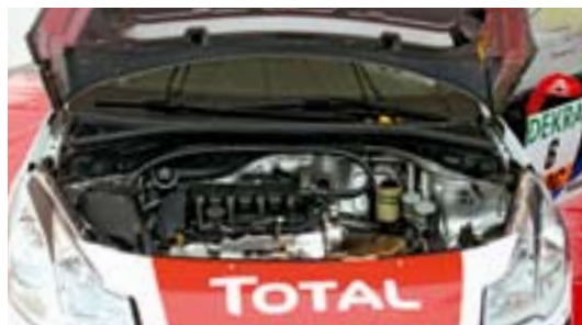
Der 1,6-Liter-Turbomotor im Citroën DS3 R3 leistet 210 PS und bringt es auf rund 205 km/h Höchstgeschwindigkeit
